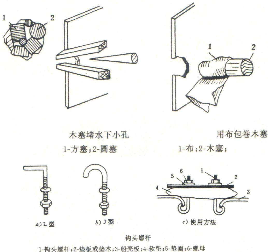
图 3-1 水线以上破口应急堵漏示意图
