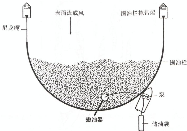
图 5-9 二船拖曳围油栏成“U”形
