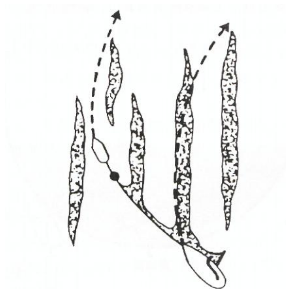
图 5-7 单船收油系统另加一船拖曳围油栏，以增加围油率
